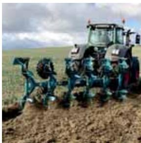
**S**TECOMAT toujours à la recherche du matériel efficace et innovant a dans sa large gamme des scalpeurs portés ou semi-portés de la marque Treffler qui sont d'une efficacité redoutable grâce aux socs patte d'oie et aux dents spécifiques en Hardox brevetées Treffler. Il permet de scalper 100% de la surface en un seul passage et ce, en maîtrisant parfaitement la profondeur de scalpage à partir de 3cm. Il assure un recroisement de 8cm de
