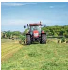
**S**a largeur de travail varie de 9,80 m à 12,50 m hydrauliquement de série ce qui permet une adaptation rapide en fonction des conditions d'utilisation. Grâce au concept d'entraînement Easy-Line KRONE, les rotors avant tournent 25 % plus vite que les arrières : les andains formés sont réguliers et optimisés pour la reprise optimale avec une presse, une remorque autochargeuse ou encore une ensileuse. Pour effectuer un travail de qualité, le réglage de la
