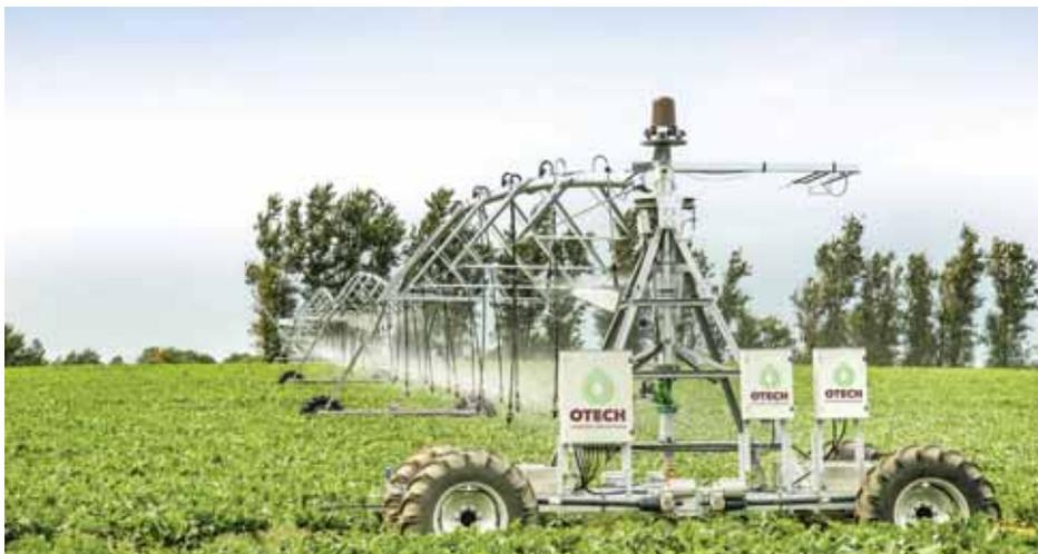
**F**ort de plus de 30 années d'expérience, le constructeur français OTECH, basé à Puyoô (64) propose désormais la gamme de pivots la plus large du marché avec des diamètres de conduite allant de 127 à 245 pour des débits pouvant atteindre les 1000 m<sup>3</sup>/h avec une pression de service très basse et peu gourmande en énergie.
