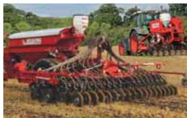
La particularité du semoir Weaving GD est que l'élément semeur, monté sur parallélogramme, a un double disque incliné qui permet de perturber très peu la surface du sol.
