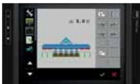
**T**oujours dans un souci d'amélioration, la gamme de bineuse de Carré ECONET propose désormais un relevage hydraulique des éléments pilotable depuis la cabine du tracteur grâce à la console ISOBUS.
