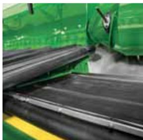
**P**our répondre à une demande accrue des clients européens pour des coupes à tapis, John Deere, premier fabricant au monde dans ce secteur, propose désormais le modèle 700FD Flex Draper. Les nouveaux joints limitent les pertes de colza de 45%, tandis que les bords ondulés des deux côtés du tapis améliorent la fiabilité en améliorant l'alignement et le guidage du tapis.
