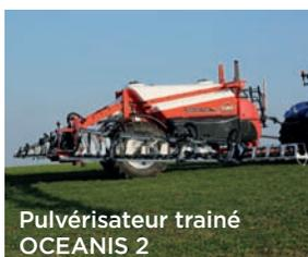
concentre sur le pulvérisateur OCEANIS 2 et son nouveau système de pulvérisation de précision MULTISPRAY DUO. Celui-ci permet au pulvérisateur de sélectionner automatiquement la buse en fonction de la vitesse d'avancement, afin de garder une pression de pulvérisation optimale. Autre nouveauté, la rampe LEA3 permet un positionnement des buses tous les 25 cm, afin de limiter la dérive d'application en positionnant celle-ci au plus près de la cible à pulvériser.
