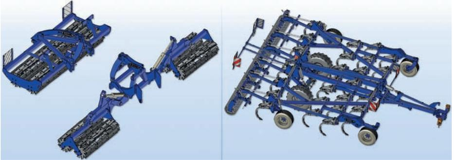
**L**a gamme ECOROULEAU s'enrichit d'un modèle GA (Groupe Arrière) : combiné à un Ecorouleau 3 m frontal, l'interface est attelée à l'arrière du tracteur et permet d'atteindre une largeur de travail de 6 à 9 m.
