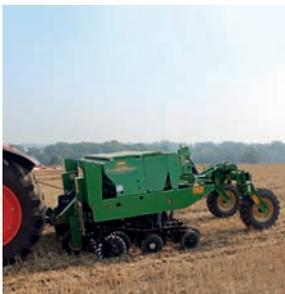
**L**e Kverneland Great Plains 3P1006NT est un semoir porté de semis direct à 2 points avec roues assistées au relevage pour assurer un fonctionnement et un transport en toute sécurité.
