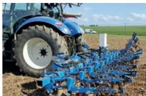
Sat'bine, système de binage piloté par GPS
