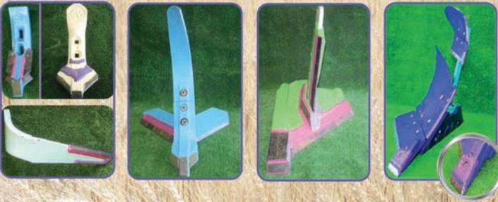
Remise en état au carbure de pièces décompacteurs usées avec des options de rechargement au fil en complément!
