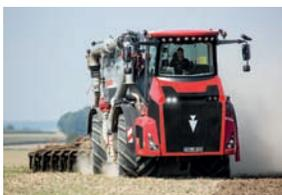
l'épandage de lisier. Cette technologie a encore été améliorée grâce à la nouvelle structure intérieure des tuyaux et la nouvelle cuve. A charge, le Terra Variant équipé de la cuve lisier Zunhammer pèse 21.6 tonnes, ce qui représente un ratio poids puissance imbattable de 36,9 kg/CV.
