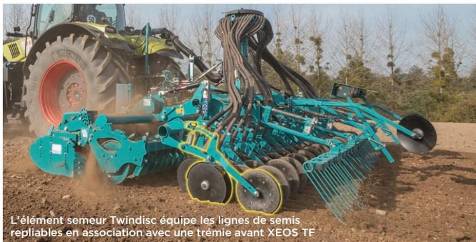
L'élément semeur Twindisc équipe les lignes de semis repliables en association avec une trémie avant XEOS TF
