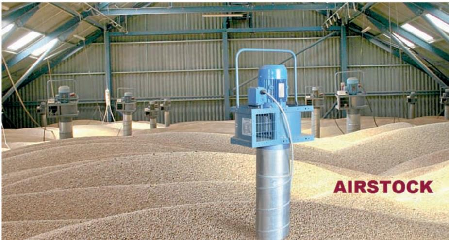
**L**e système de ventilation des céréales par aspiration (dépression) AIRSTOCK est constitué de colonnes verticales, que l'on pose simplement sur le sol, avant de déverser le grain. On place ensuite l'aspirateur en haut de la colonne, qui va aspirer l'air à travers le tas, de haut en bas, et donc refroidir le grain, pour le ramener rapidement au taux de stabilisation et de conservation.
